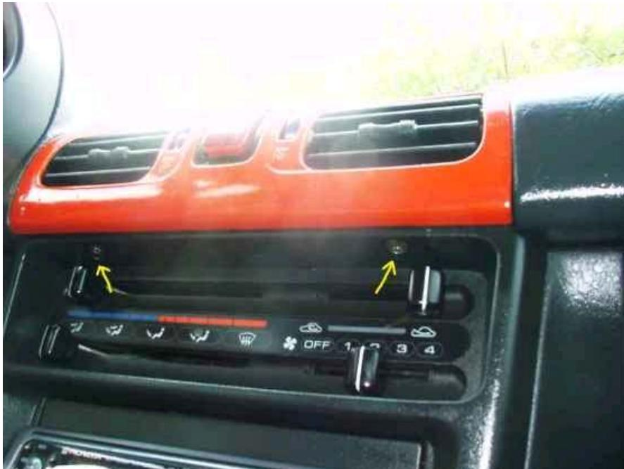
Beim Einbau sollte drauf geachtet werden das die Luftkanäle wieder auf den Lüftungsschacht passen.
